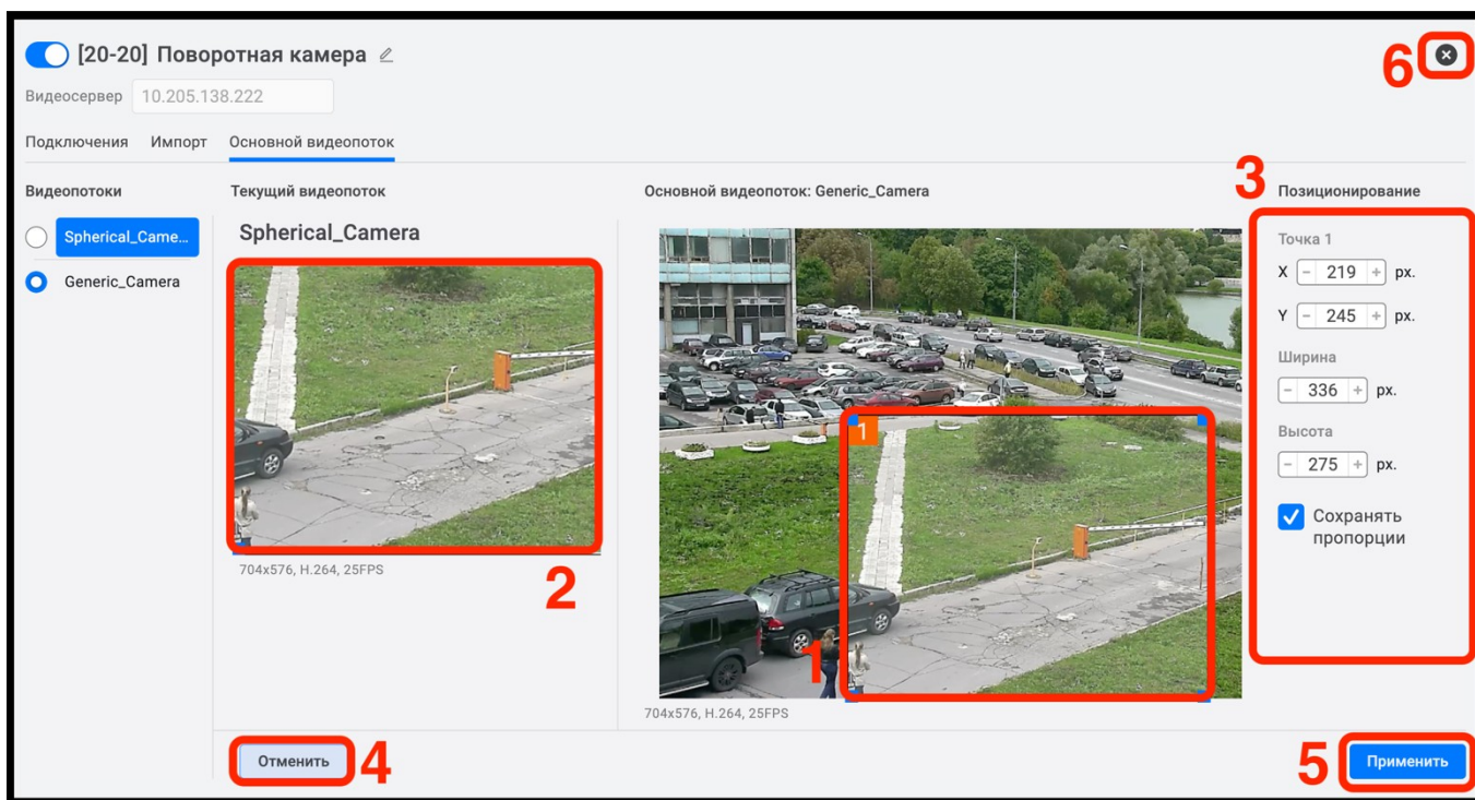
Рисунок 50 – Настройка зоны детального просмотра видеопотоков для поворотного устройства, работающего по протоколу ONVIF
